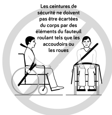
Figure 3a - Mauvais positionnement de la ceinture au niveau du bassin sur les supports du fauteuil roulant.
