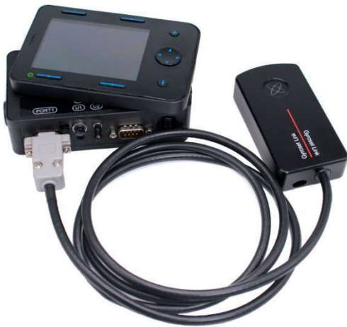
Connexion du Link à l'Omni
